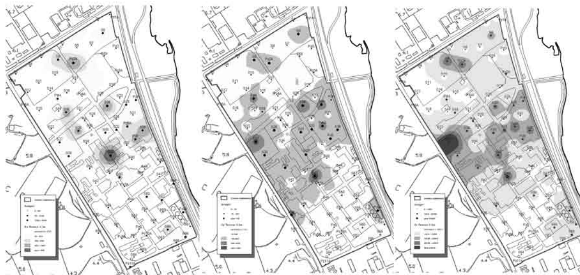
Figura 3. Distribución de la concentración de As, Cd, Zn (de izquierda a derecha) en el estrato de suelo comprendido entre 1 y 3 m (Distribution of As, Cd, Zn concentration ( from left to right) in the layer between 1 and 3 m)
