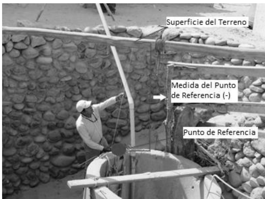
Imagen 2. Medición del punto de referencia debajo de la superficie
