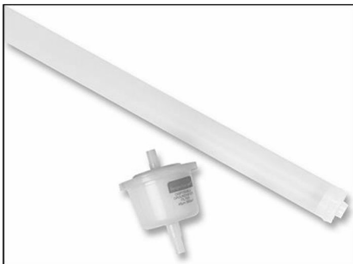
Figura 16 Muestreo en pozos profundos utilizando un bailer.
