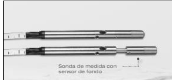
Figura 2 Tipo de sondas con sensor de fondo.
