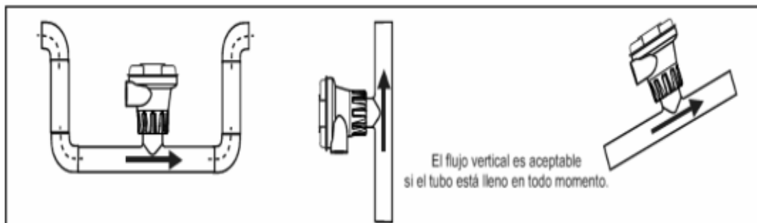
Figura N° 2 Disposición de la incorrecta instalación del medidor
